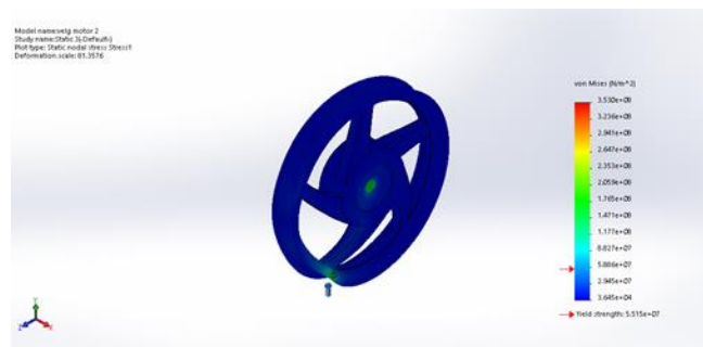
Gambar 4. 5 simulasi von mises stress dengan ketinggian lubang 40 mm
