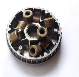
Gambar 1. Roller CVT pada Movable Drive Face/Primary Sliding Sheave
