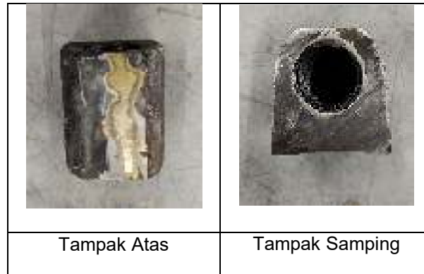
Gambar 4.10 Hasil pengelasan mur eretan meja dengan menggunakan kuningan.
