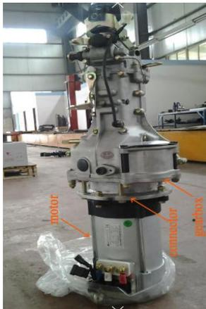
**Gambar 5.** Gambar Motor AC 3 phasa [Error! Reference source not found.] dan Rangkaian motor dengan gear boxnya
