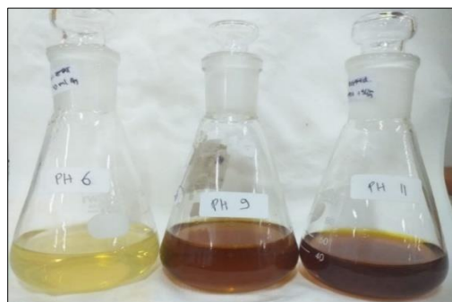
Gambar 2. Perubahan warna larutan pada proses sintesis nanopartikel perak dengan menggunakan bioreduktor ekstrak ampas jeruk nipis dengan variasi pH 6, 9 dan 11 suhu 100o C selama 3 jam
