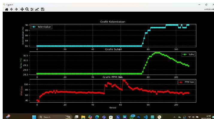
Gambar 7. Pengujian Sensor DHT-11
