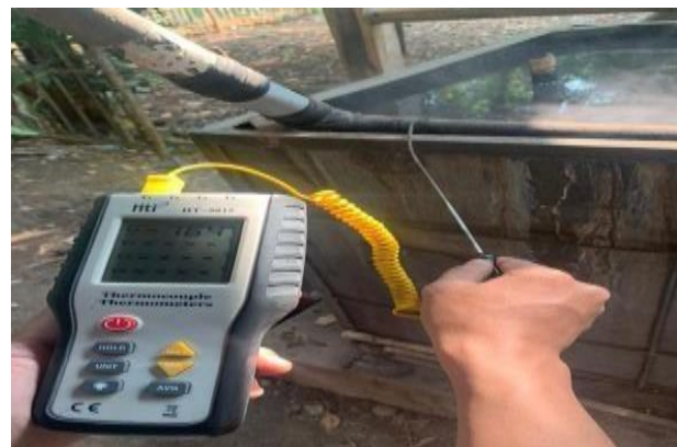
Gambar 2. Thermocouple yang digunakan dalam proses pengambilan data suhu.
