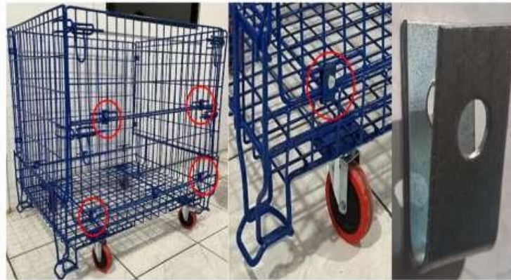
Gambar 6. Implementasi dies dan punch pada clamping trolley
