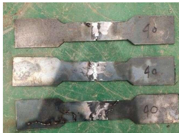
Gambar 13. Hasil Pengelasan pada arus 40 A pada plat baja sphc 1 mm
