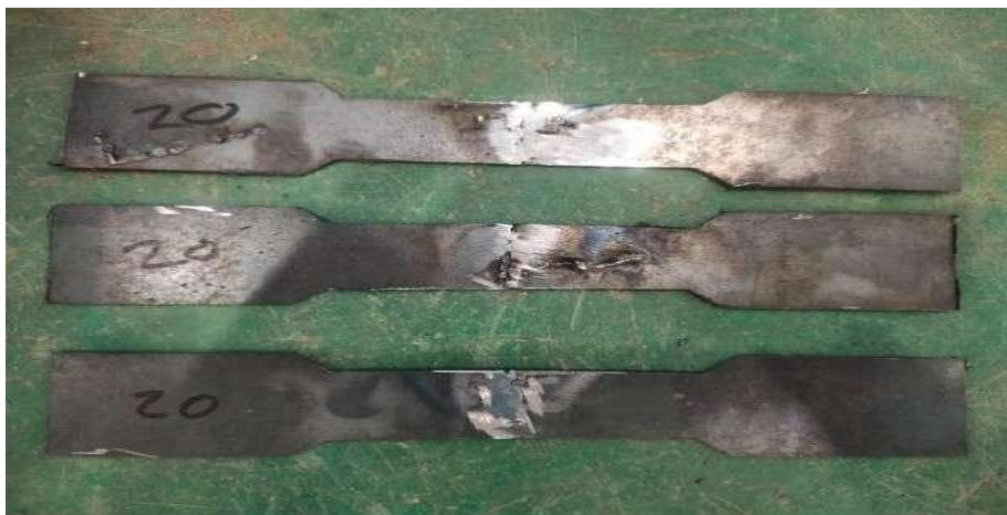
Gambar 11. Hasil Pengelasan pada arus 20 A pada plat baja sphc 1 mm
