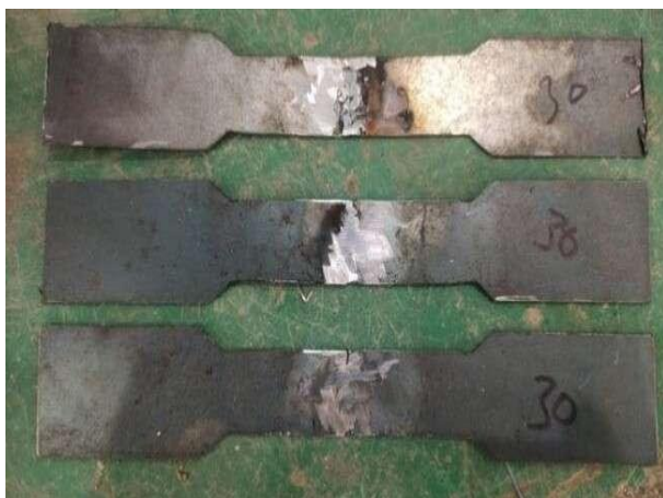
Gambar 12. Hasil Pengelasan pada arus 30 A pada plat baja sphc 1 mm
