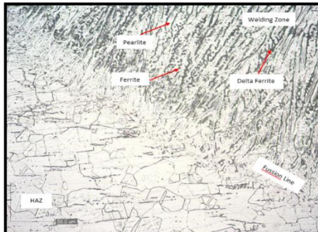
Gambar Foto mikro pengelasan 75A pada area fusion line
